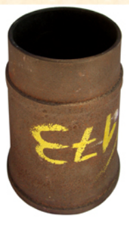
Le sabot à deux demi-coquilles fixes pour les bouteilles à panse cylindrique ou prismatique. Il a les mêmes dimensions que le moule.
