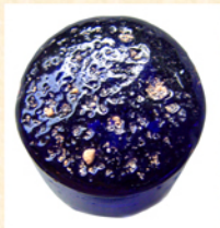
Le pontil en verre au sable la paraison est marbrée sur du sable pour les fonds épais, se détache rapidement
