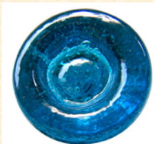
Le pontil en verre, commun pour les fonds épais, plats ou rentrants. Colle localement.
