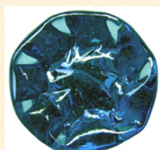
Le pontil en verre en couronne pour les fonds minces, collage par les excroissances des festons.
