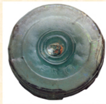
Le pontil en fer chauffé au rouge s'applique aux fonds épais de l'Antiquité au XIXe s.
