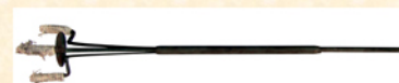
Le sabot à griffes mobiles transformation du précédent, adapté aux pièces à panse cylindriques et prismatiques de différentes dimensions (fin du XIXe s.)
