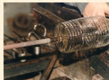
Le pontil avec le mors de canne pour les fonds épais des bouteilles
