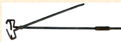
Le sabot en tenailles Pour les grosses pièces (type urne dès le 1 er s. de notre ère) qui possèdent un pied dégagé par resserrement du bas de la panse.
