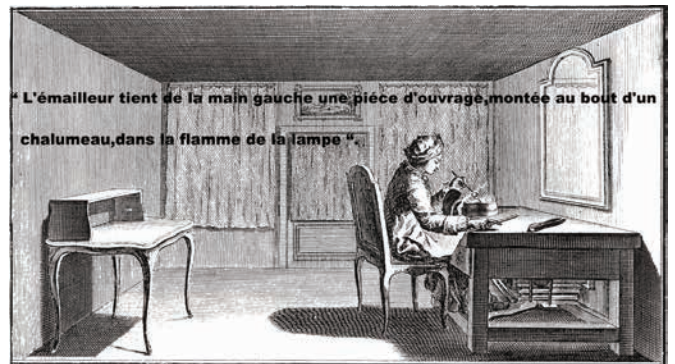
Fig. 1.- La vignette représente l'intérieur d'une arrière-boutique ou d'un cabinet, dont tous les jours sont fermés par des rideaux, afin que l'émailleur puisse mieux voir la flamme de la lampe. L'émailleur tient de la main gauche une pièce d'ouvrage, montée au bout d'un chalumeau, dans la flamme de la lampe.
