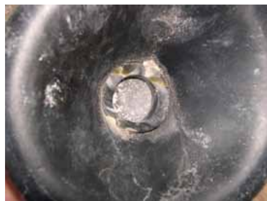
Fig. 4 Fond de bouteille en verre noir avec une marque de pontil à la canne, 1838. (© L. Serra)
