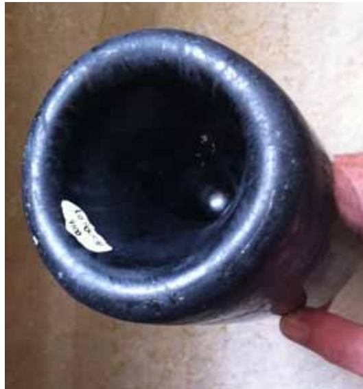
Fig. 3 Fond de bouteille en verre noir sans marque de pontil mais portant la déformation due probablement à la pince de préemption lors de son transfert vers le four de recuisson, 1838. (© L. Serra)
